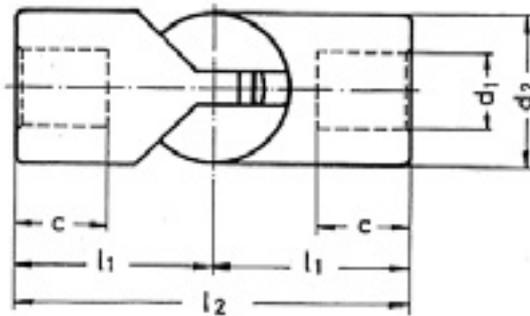
Bezeichnung eines VEXIER - Kugelgelenkes Ausführung B, **einfach** mit  $d_1 = 8$  mm
